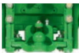
Einschub für Kugelkopfanhängung – AL225421
