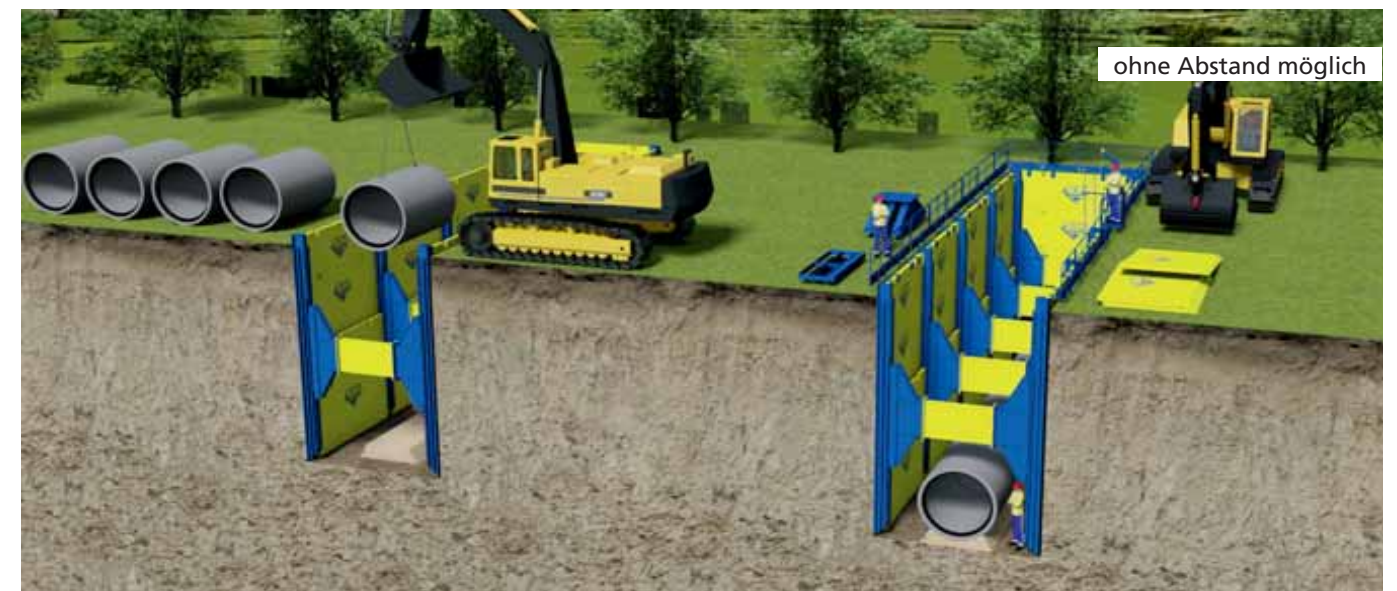
Abb. 22: Verbaute Gräben und Baugruben
