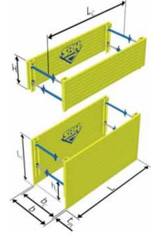
Der Leichtverbau 100er Serie ist ideal für den kleinen bis mittleren Kanalverbau und den Einsatz leichter Baumaschinen.
