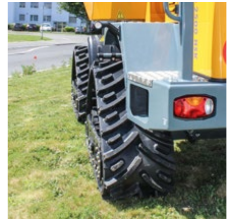
2'250 mm Gesamtbreite, Bodendruck 31.7 kPa (leer) und 59.2 kPa (beladen)
