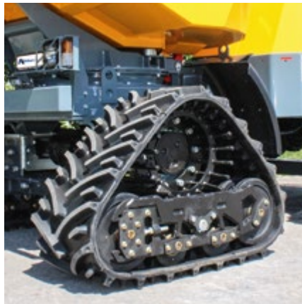
Die Pendelaufhängung der Raupen erhöht den Bodenkontakt.
