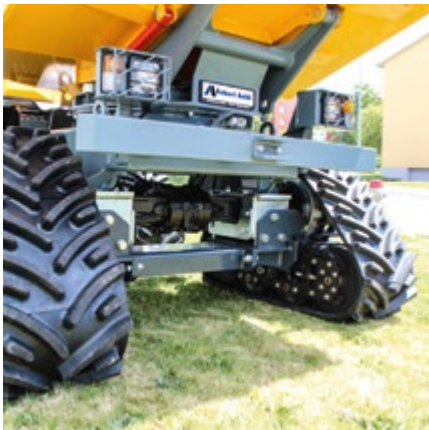
Hohe Stabilität durch Zusatzrahmen bei gleichzeitiger Entlastung der Achsen.
