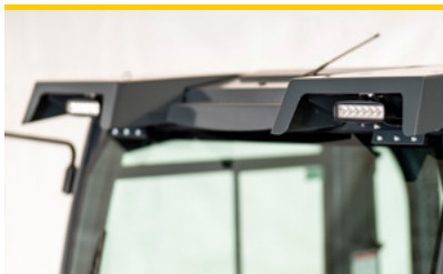
LED-Arbeitsscheinwerfer zur optimalen Ausleuchtung des Arbeitsbereiches
