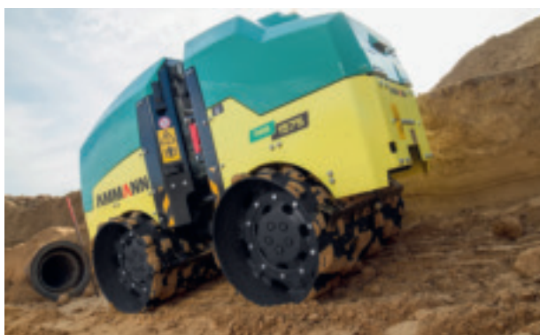
Rouleaux de tranchées Ammann Compresseur polyvalent articulé avec une puissance de compression élevée, même sur sol meuble.
