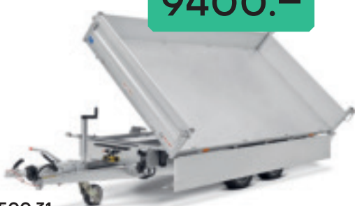
HTK 3500.31 Dreiseitenkipper Gesamtgewicht: 3500 kg Nutzlast: 2550 kg
