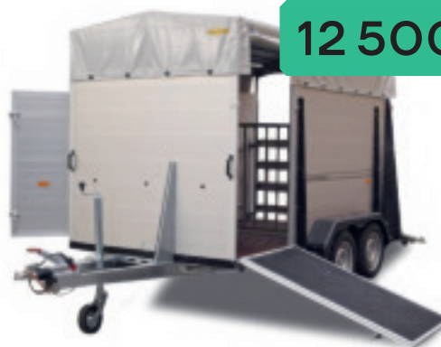
HTV 243016 Swiss Édition Bétaillère Poids total: 2600 kg Charge utile: env. 1862 kg Pneus: 14 pouces
