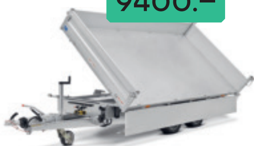
HTK 3500.31 Remorque basculante à trois côtés Poids total: 3500 kg Charge utile: 2550 kg
