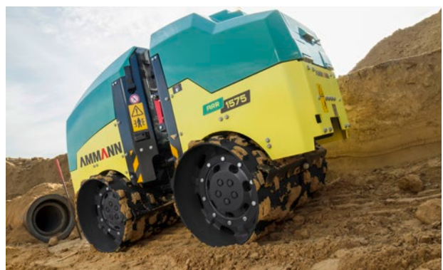
Ammann Grabenwalzen Knickgelenkter Mehrzweckverdichter mit hoher Verdichtungsleistung auch auf weichem Untergrund.
