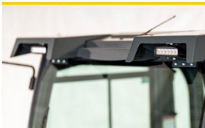
LED-Arbeitsscheinwerfer zur optimalen Ausleuchtung des Arbeitsbereiches
