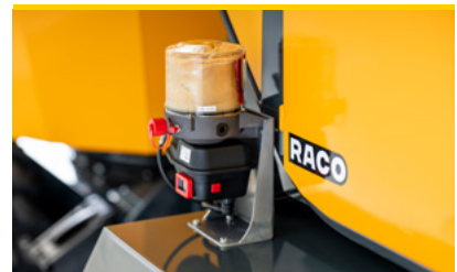
Zentralschmieranlage: Spart Zeit, reduziert Verschleiss und senkt Wartungskosten
