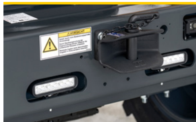
LED-Arbeitsscheinwerfer in der Heckstossstange
