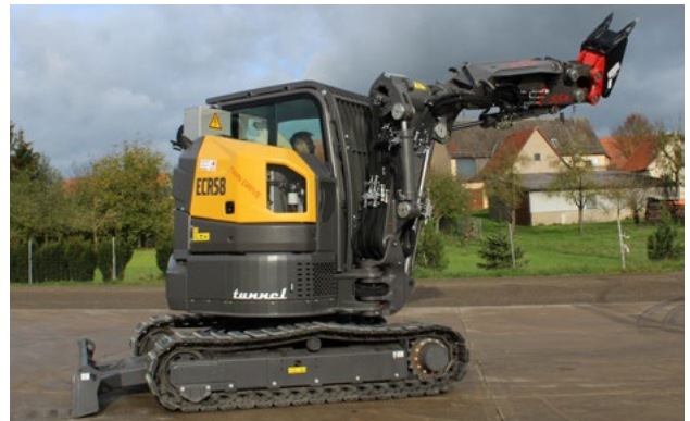
Volvo Kompakt-Tunnelbagger ECR58-T mit Twin-Drive, d. h. Dieselmotor für konventionellen Betrieb sowie zusätzlich integriertem Elektroantrieb mit Kabeltrommel für emissionsfreien Dauereinsatz
