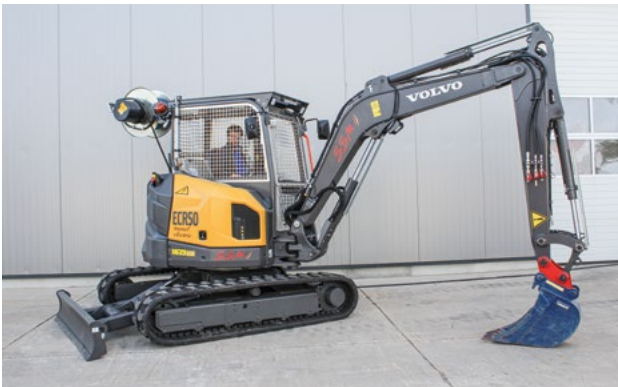
Volvo Kompaktbagger ECR50 mit Elektroantrieb inkl. Kabeltrommel sowie zusätzlicher Funkfernsteuerung mit Kameraüberwachungssystem, für einen Untertage-Bergwerkeinsatz
