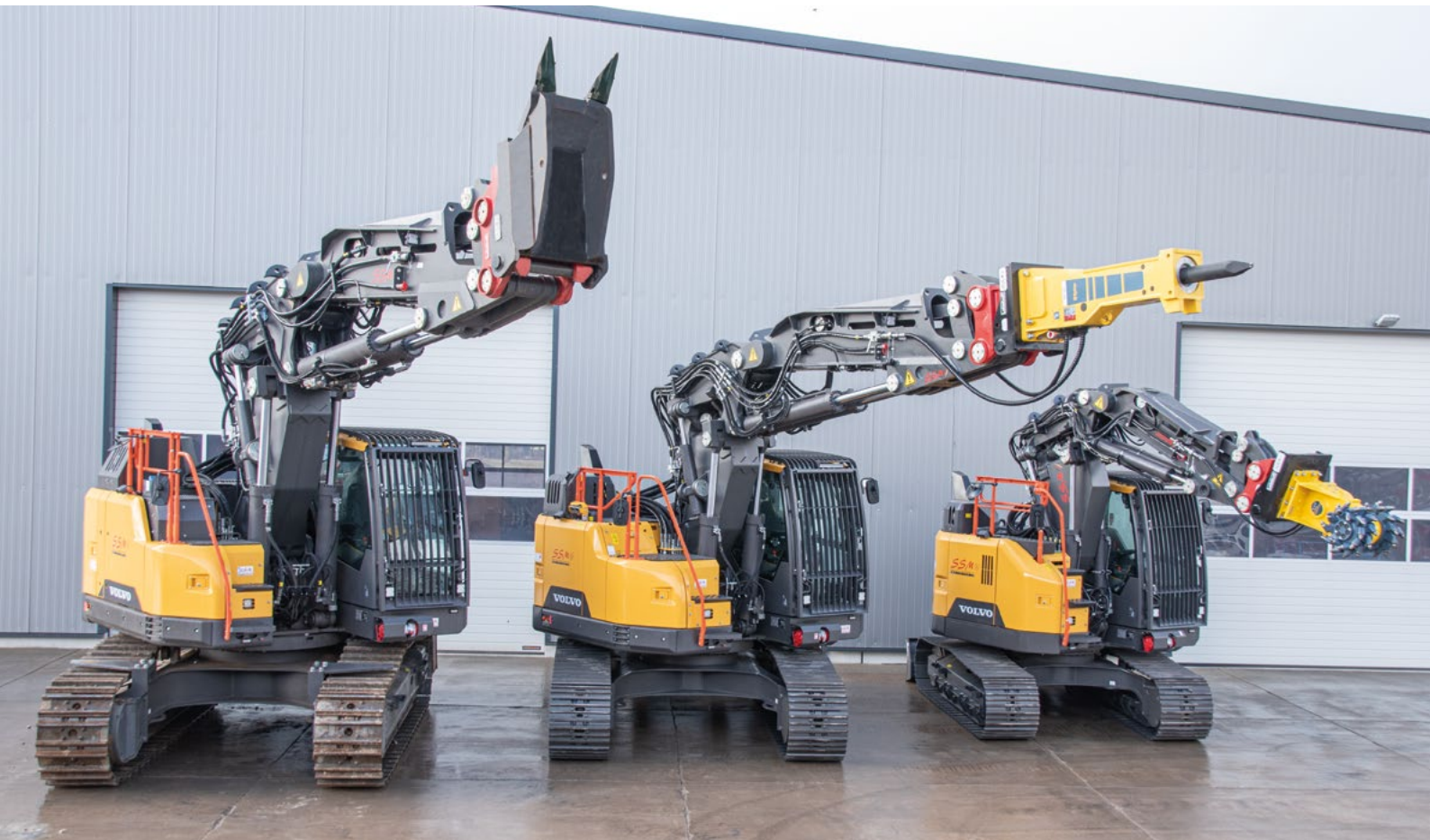
Volvo ECR355-T mit Reißlöffel, ECR235-T mit Hydraulikhammer, ECR145-T mit Felsfräse (v.l.n.r.)
